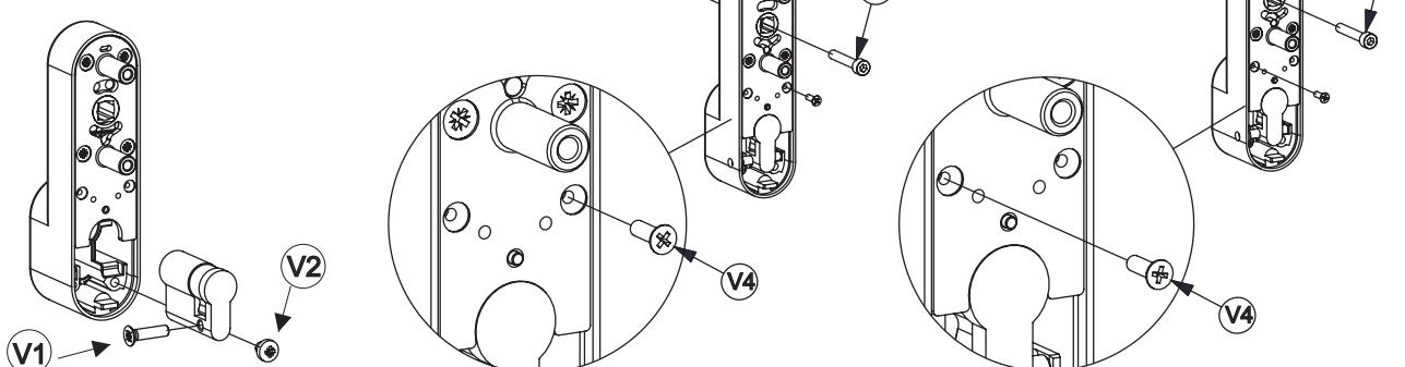
Einbau/Ersatz des Zylinders und Bestimmung der Öffnungsrichtung
